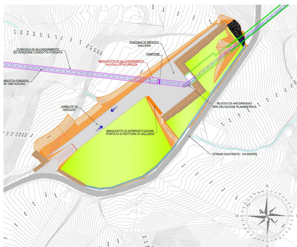
Fig. 5.14 - Condotta forzata e piazzale di accesso alla galleria
